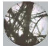
Um über Jahrzehnte hinweg eine konstante Dämmleistung zu erbringen, ist es wichtig, dass der Dämmstoff seine Form und sein Volumen behält. Beim Einblasen von STEICOzell kommt es zu einer dreidimensionalen Verzahnung und Verkrallung der einzelnen Holzfasern untereinander (Mikroskopaufnahme). Selbst bei geringen Rohdichten wird dadurch ein höchstes Maß an Setzungssicherheit bei hoher Elastizität garantiert.
